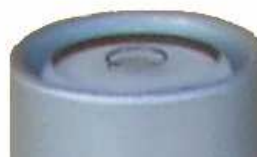
Middels de waterpas in de mast het geheel waterpas stellen voordat het platform wordt geïnstalleerd.
