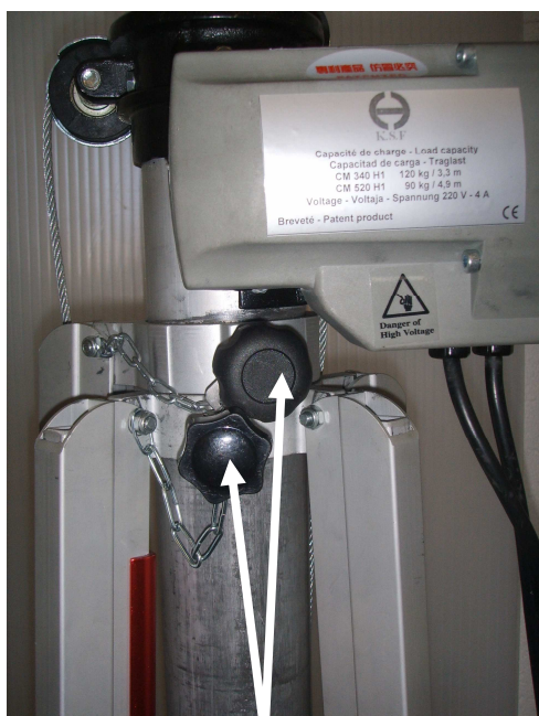
CM340 2 borgschroeven losdraaien CM 520 1 borgschroef losdraaien
