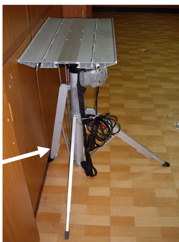
CM 340 Deze voet kan direct tegen de wand geplaatst worden
