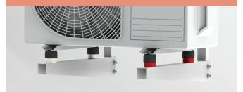
THE RED FEET MUST BE INSTALLED ON THE OPPOSITE SIDE OF THE GRILL
